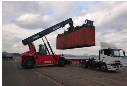
リーチスタッカー 2 台 例：コンテナ積込作業
