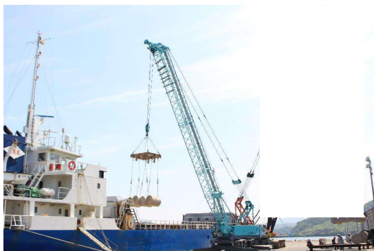
50T機械式クレーン1台 例：ロール紙荷役
